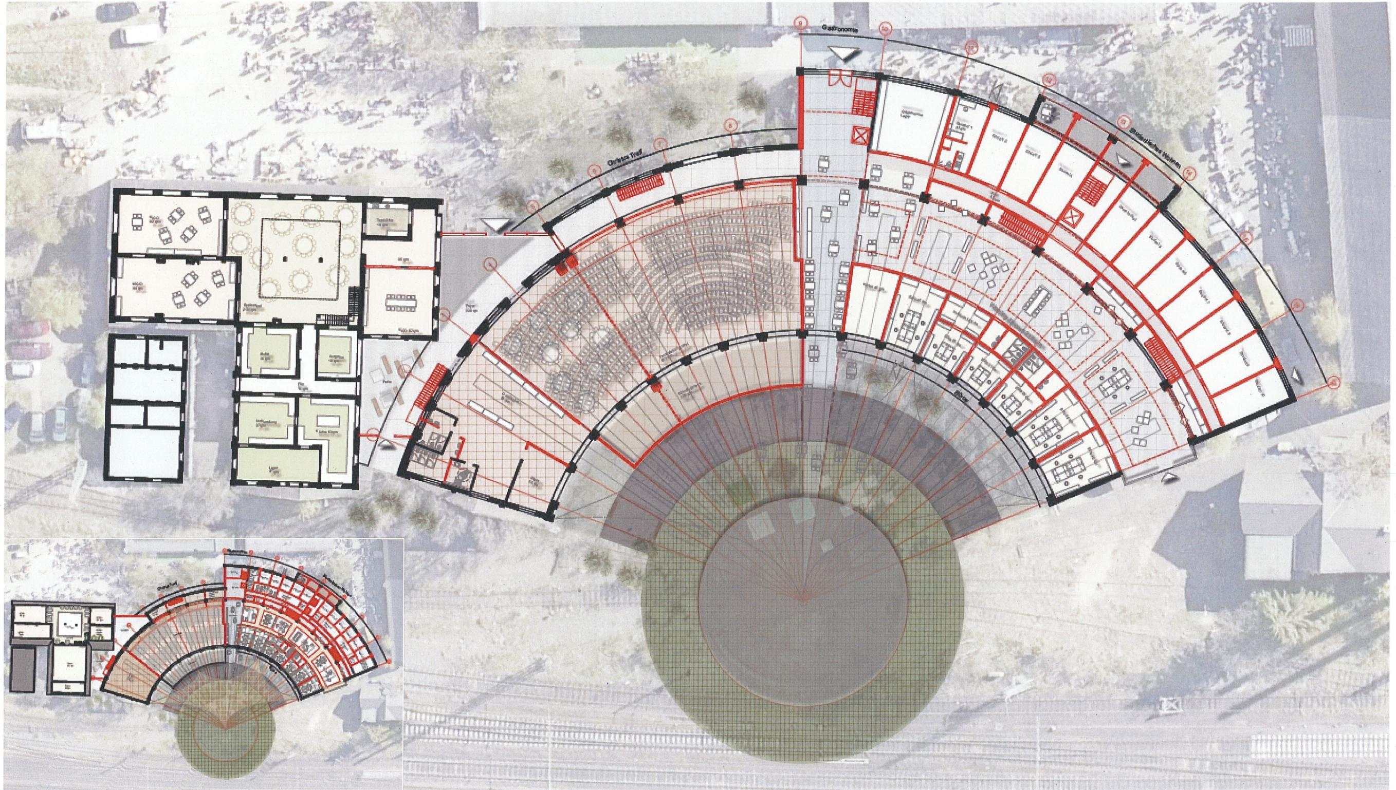
8) Grundriss Ringlokschuppen mit Darstellung geplanter Innenraumnutzung, inklusive Freiflächenplanung; Erdgeschoss M= 1: 200 (verkleinert: Obergeschoss)
