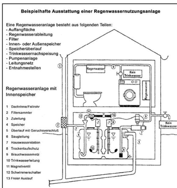
Abbildung 14: Schemaskizze - Regenwassernutzung
