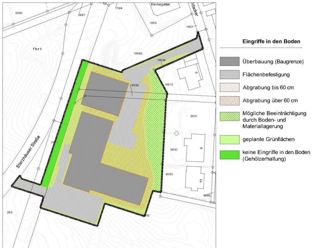
Abbildung 7: Eingriffe in den Boden
