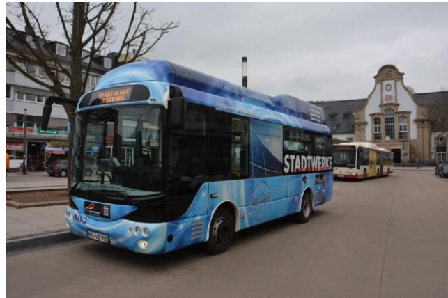
Abbildung 24: Midibus mit batterieelektrischem Antrieb
