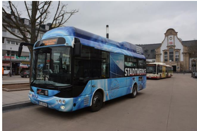
Abbildung 24: Midibus mit batterieelektrischem Antrieb
