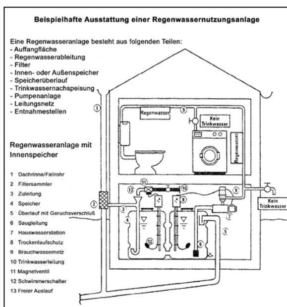
Abbildung 14: Schemaskizze - Regenwassernutzung
