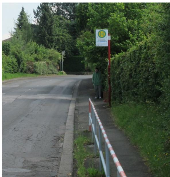
**Haltestelle Wehrhausen Zur Weinstraße:** Barrierefreier Ausbau erfordert breitere Gehwege um Zuwegung, Aufstellung sowie Aus- und Einstieg mit Rollstuhl oder Rollator zu ermöglichen
