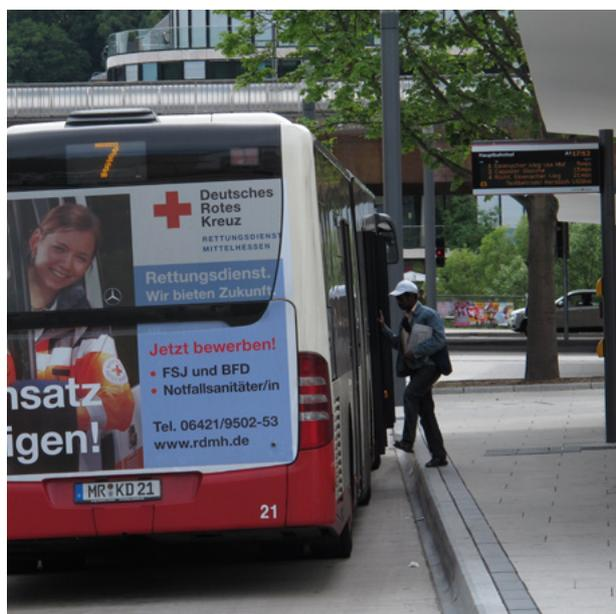
Bei dieser Spaltbreite ist ein Ein-/Ausstieg an der zweiten Tür erschwert und ein Ausklappen einer Rollstuhlrampe nicht möglich.
