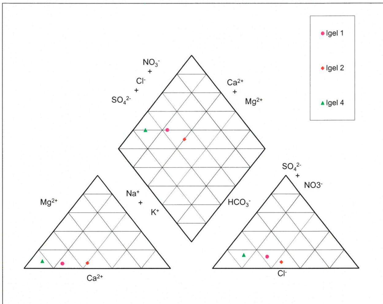
Abbildung 2: Darstellung der Ionenverhältnisse im Piper-Diagramm für den 24.04.2015 - Bereich Bauschuttanlage Igelpfuhl
