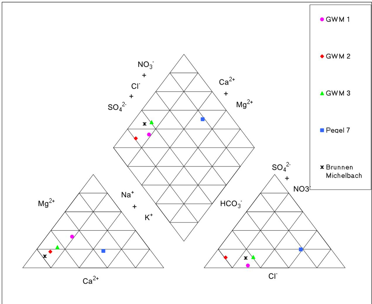
Abb. 1: Darstellung der Ionenverhältnisse im Piper-Diagramm für den 14.10.2011
