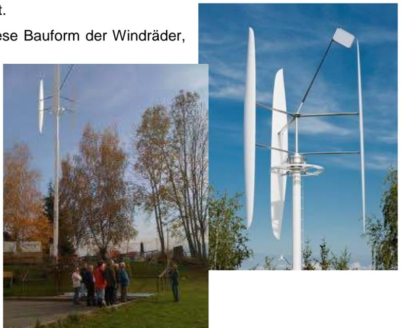
Abb. 35: Beispielhafte Darstellung eines Kleinwindrades mit vertikaler Drehachse
