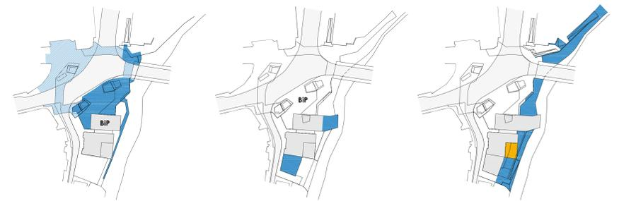
Neubau des Gebäudes unter der Platzebene und Platzgestaltung. Erstellung der notwendigen Verkehrsflächen auf Platzebene unter Erhalt der derzeitigen Nutzungen. Erstellung der Mauer zum permanenten Hochwasserschutz.
